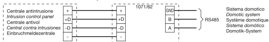
**Collegamento ingressi ausiliari / Auxiliary inputs connection / Connexion entrées auxiliaires / Conexión entrada auxiliar / Anschluss der Hilfseingänge**
