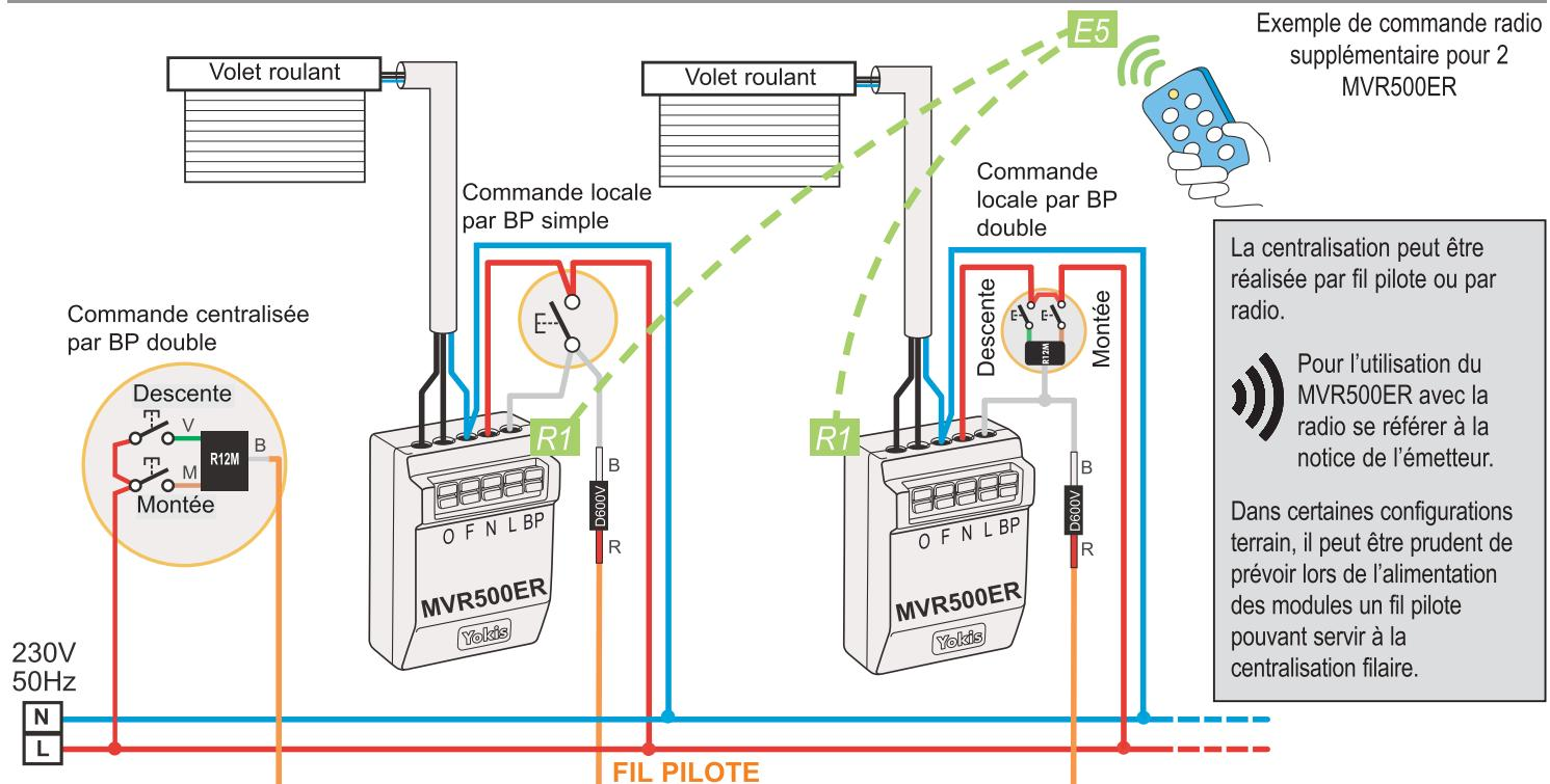
Le micromodule doit être uniquement installé par une personne formée et dans un lieu inaccessible à l'utilisateur final, conformément aux règles d'installation nationales (NFC 15-100 en France).
