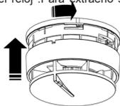
Los detectores tienen un sistema de bloqueo para ayudar a evitar la extracción no autorizada del detector. Tal como se suministra, los detectores pueden ser extraídos sin el uso de una herramienta de extracción (opción útil para los techos altos).
