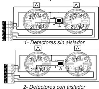
En caso de instalar un piloto de acción también será imprescindible respetar la polaridad de la instalación como se muestra en los esquemas anteriores.
