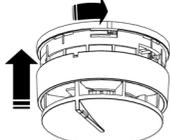
Les détecteurs sont pourvus d'un système d'ancrage qui empêche leur retrait sans recourir à l'emploi d'un outil. Pour utiliser l'ancrage, il est nécessaire de couper la languette représentée sur la figure suivante. Pour utiliser le mécanisme de verrouillage, il suffit de couper la languette comme illustré sur la figure ci-dessous. Les détecteurs dont la languette a été coupée ne peuvent être retirés qu'à l'aide d'un outil (un petit tournevis, par exemple).
