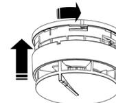
I rivelatori dispongono di un sistema di ancoraggio che evita che un rivelatore possa essere estratto senza l'utilizzo di uno strumento. Per utilizzarlo è necessario tagliare il pezzettino di plastica come indicato nel disegno seguente.
