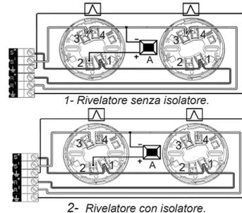
Nel caso dell'installazione di un ripetitore ottico è necessario rispettare la polarità dell'installazione come indicato nello schema.
