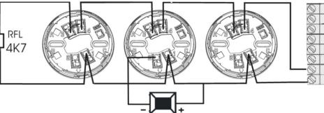
Nel caso dell'installazione di un ripetitore ottico è necessario rispettare la polarità dell'installazione come indicato nello schema. La centrale utilizzata nell'installazione, deve avere una limitazione di corrente di 100 mA.
