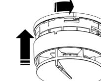
I rivelatori dispongono di un sistema di ancoraggio che evita che un rivelatore possa essere estratto senza l'utilizzo di uno strumento. Per utilizzarlo è necessario tagliare il pezzetto di plastica come indicato nel disegno seguente.
