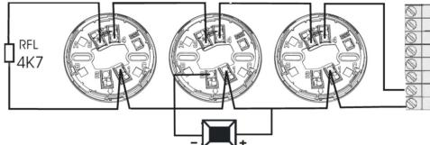
Nel caso dell'installazione di un ripetitore ottico è necessario rispettare la polarità dell'installazione come indicato nello schema. La centrale utilizzata nell'installazione, deve avere una limitazione di corrente di 100 mA.
