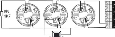
En cas d'installation d'un voyant d'activité, il s'avère indispensable de respecter la polarité du montage, comme indiqué sur le schéma précédent. La centrale utilisée dans l'installation doit être pourvue d'une limitation de courant de 100 mA.
