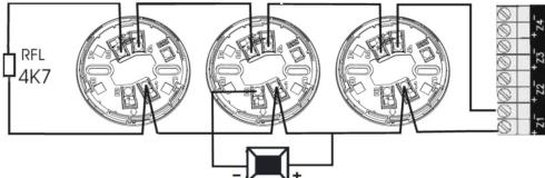
En caso de instalar un piloto de acción, será imprescindible respetar la polaridad de la instalación como se muestra en el esquema anterior. La central que se use en la instalación, debe disponer de una limitación de corriente de 100 mA.
