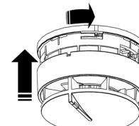
Los detectores tienen un sistema de bloqueo para ayudar a evitar la extracción no autorizada del detector. Tal como se suministra, los detectores pueden ser extraídos sin el uso de una herramienta de extracción (opción útil para los techos altos).
